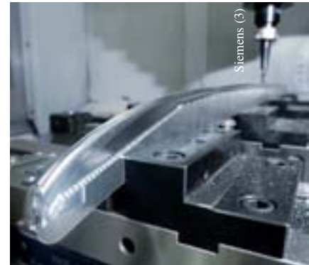
Hightech für Weltmeister: Eine computergesteuerte Fräse gibt der Kufe den letzten, präzisen Schliff.
