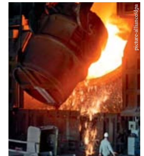
Geschmolzenes Roheisen wird aus einer Pfanne in einen Konverter gegossen und dort mit Eisenschrott vermischt.
